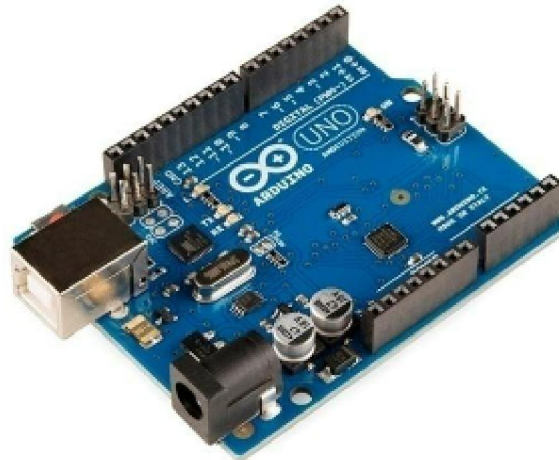
Figure: Arduino UNO
