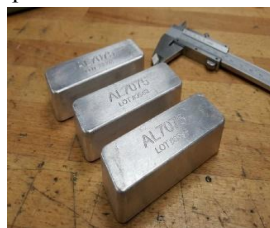
Fig. 3.1 Al7075 Alloy ingots
