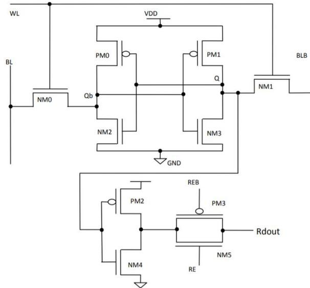
**Figure 3: 10T SRAM cell**
