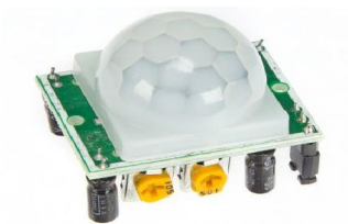
Fig. 3.3.4. PIR Motion Sensor
