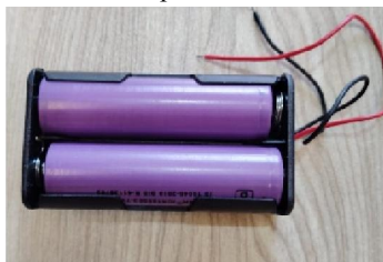
Lithium Ion Batteries (x2)
