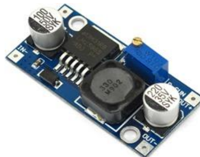
Fig 12. DC-DC Buck Converter
