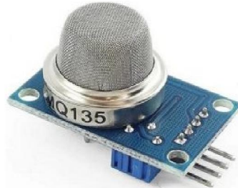
Figure:3 So2 SENSOR or MQ135 Air Quality Sensor
