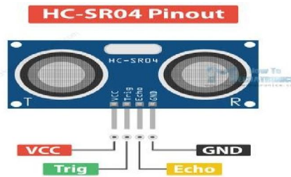
Fig: ultrasonic sensor
