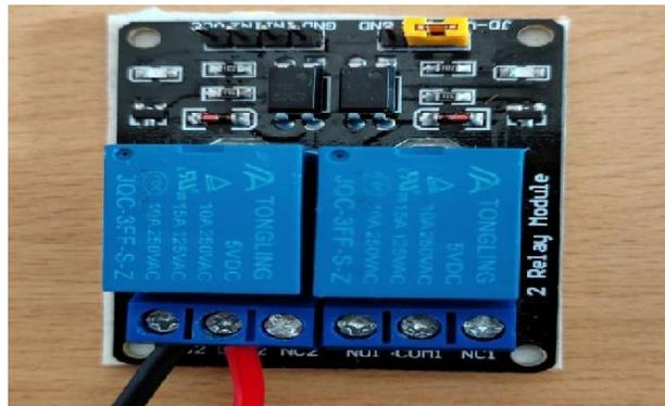
**Figure 6:** Relay module
